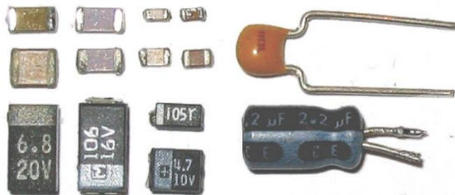
Un *condensatore* è un dispositivo utilizzato in elettronica per immagazzinare corrente e carica.
